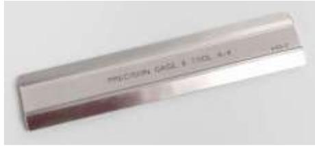
El raspador A-4 tiene dos bordes con .015 "radio que hace el contacto de la línea. Destinado para uso con algunos medidores especiales. Este raspador viene en un acabado de acero inoxidable 440-C. Importante.
