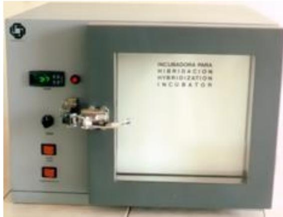
Para Hibridación de ADN, control electrónico digital de temperatura desde ambiente hasta 100° C, con exactitud de  $\pm 0.1^\circ$  C, sensibilidad de  $\pm 0.5^\circ$  C a 100° C, interior de acero inoxidable de 33 x 33 x 33 cm. Incluye rotor de acero inoxidable y gira a 15 r.p.m., Capacidad para 10 tubos de 38x300mm. Se incluyen 10 tubos de 38x300 y 10 de 35x300mm. Opera con 120 volts.
