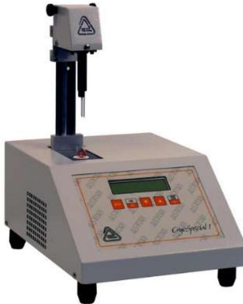
**CryoSpecial 1 es un crióscopo muy accesible para la rápida y exacta determinación de la variación del punto de congelación de leche/nata y del porcentaje de agua añadida, con prestaciones analíticas según las normas de referencia IDF-ISO 5764:2009 y AFNOR**
