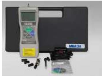
El dinamómetros IM-DS2110 es un equipo que no obstante su simpleza de operación cuenta con una alta precisión a un precio adecuado. Su carcasa metálica ergonómica es útil en ambientes industriales.
