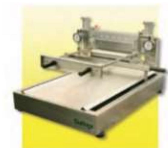
Para recubrir materiales textiles o papel con polímeros sintéticos, hule natural, etc. y conducir pruebas de resistencia química, resistencia UV, estabilidad térmica, resistencia al fuego, fuerza, impermeabilidad, aislamientos térmicos, resistencia a la abrasión, etc.
