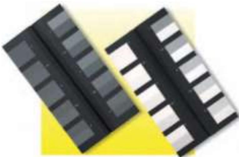
Escala de Grises para la evaluación del manchado o no manchado de los textiles y de los cambios de color resultantes de las pruebas de solidez del color. Normas que cumple: ISO 105-A02 e ISO 105-A03
