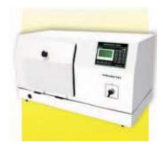
Equipo para determinar la solidez del color simulando la luz solar mediante luz de arco de Xenón ideal para diversos materiales como textiles, piel, hule, plásticos, pinturas, etc. Normas: AATCC16, ISO 105-B02, ISO 4892
