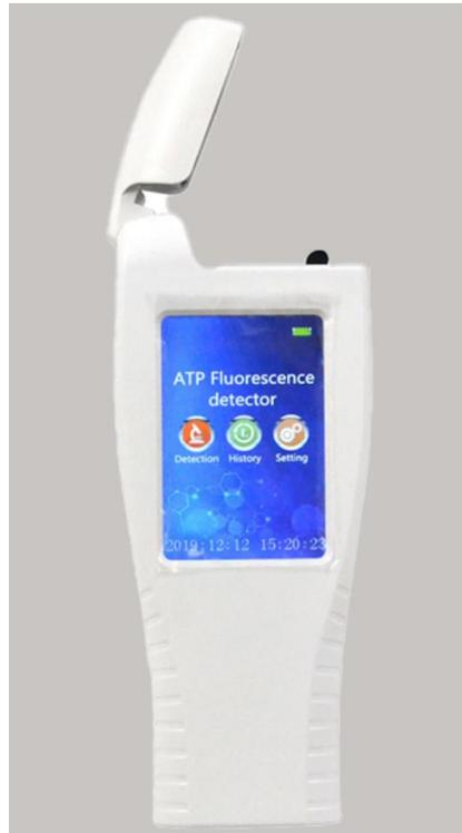
El dispositivo es un nuevo producto actualizado con una gran pantalla táctil en lugar de un botón tradicional. La operación utiliza un método de reacción bioquímica para detectar el contenido de ATP. La ATP El detector de fluorescencia se basa en el principio de luminiscencia de luciérnaga y utiliza el "sistema de luciferasa-fluoresceína" para detectar rápidamente trifosfato de adenosina (ATP).
