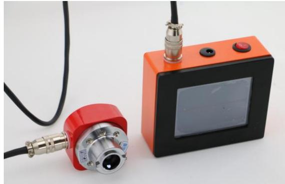
Medidor de ancho de grieta
