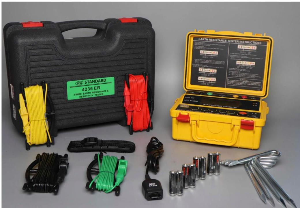
Probador de resistencia de tierra / resistividad de tierra de 4 cables
