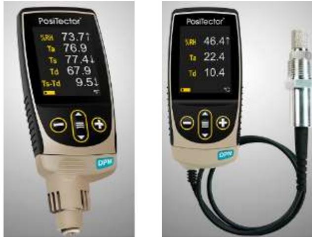
Mide y registra las condiciones climáticas incluyendo: Humedad relativa, temperatura del aire, temperatura de la superficie, temperatura del punto de rocío, velocidad del viento y diferencia entre las temperaturas de superficie y punto de rocío. Ideal para la preparación de superficies según las normas ISO 8502-4, BS 7079-B4, ASTM D3276, IMO PSPC, SSPC-PA7 y US Navy NSI 009-32.
