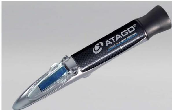
El refractómetro es un aparato para el análisis de la miel. Al cuantificar una propiedad física, el índice de refracción, informa sobre la composición química de la miel. Con este instrumento óptico se puede medir rápidamente el contenido en agua de la miel (% humedad).
