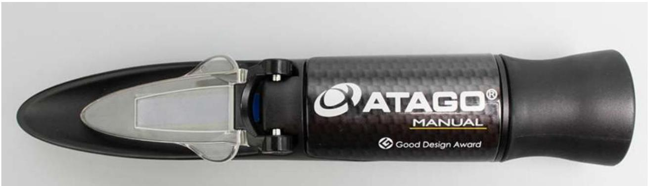
Este refractómetro tiene una escala exclusiva para medir la gravedad específica de fluidos de batería y para revisar el punto de congelación de etileno glicol y propileno glicol. Este modelo es el sucesor del BC-2E. La escala mide en °C.
