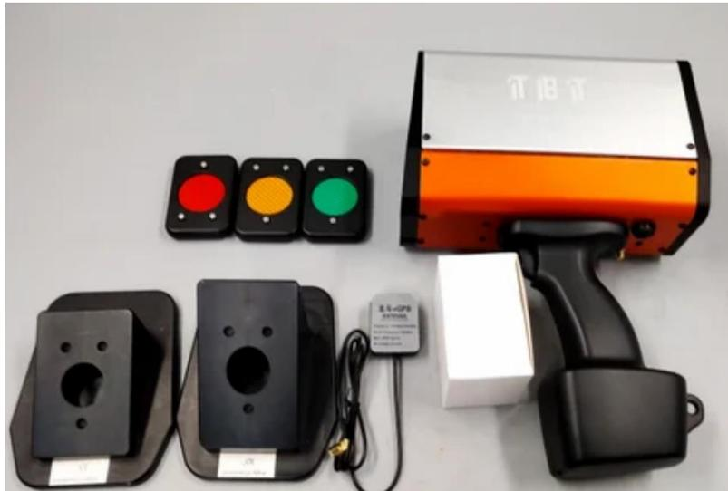
El **retroreflectómetro TBTTSR1M** es un instrumento para medir RA (retroreflexión nocturna) en señales de tráfico, alta ropa de visibilidad, cinta de visibilidad y matrícula.
