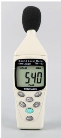
Este sonómetro ha sido diseñado para cumplir con los requisitos de medición de ingenieros de seguridad, salud, oficinas de seguridad industrial y control de calidad en diversos entornos. Varía de 30dB a 130dB en frecuencias entre 31.5HZ y 8 KHZ. Pantalla con pasos de 0.1dB en una pantalla LCD de 4 dígitos. Con dos niveles de presión acústica ponderados equivalentes, A y C
