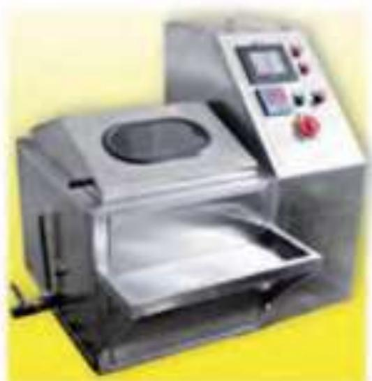
Equipo de tintura de temperatura atmosférica adecuado para hacer pruebas de tintura de algodón, lino, viscosa, etc. y con colorantes directos, ácidos, básicos, azo, reactivos, etc. también es capaz de blanquear y teñir con un radio bajo de licor. Volumen de licor: 1.8 lt.
