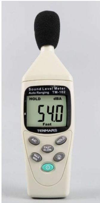
Este sonómetro ha sido diseñado para cumplir con los requisitos de medición de ingenieros de seguridad, salud, oficinas de seguridad industrial y control de calidad en diversos entornos. Varía de 30dB a 130dB en frecuencias entre 31,5 HZ y 8 KHZ. Pantalla con pasos de 0.1dB en una pantalla LCD de 4 dígitos. Con dos niveles de presión acústica ponderados equivalentes, A y C.
